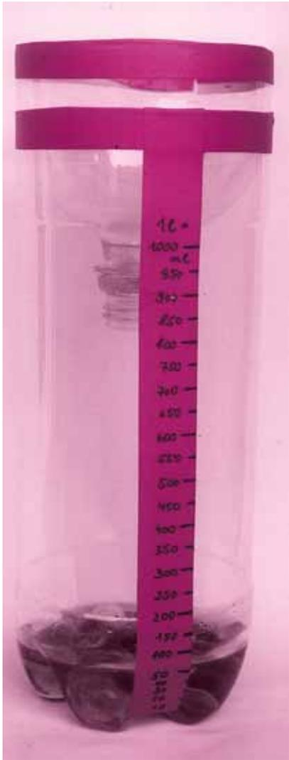
Nachdem das Wasser aus dem Auffangbehälter entfernt wurde, werden die Murmeln wieder hineingetan, da sonst falsche Ergebnisse gemessen werden. Anschließend kommt der Trichter in den Auffangbehälter und der Regenmesser ist fertig. Er wird an eine freie Stelle nach draußen gestellt.
